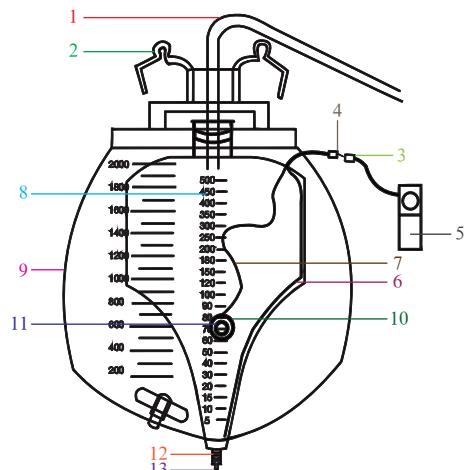
注：1 为引流入口管，2 为挂钩，3 为子接头，4 为母接头，5 为报警器，6 为 B 电极线，7 为 A 电极线，8 为刻度线，9 为引流袋本体，10 为磁铁石，11 为金属定位球，12 为排液阀，13 为引流出 口管
